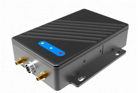
HG-JC-TSI110 是上海海积推出的北斗高精度车载终端, 采用 BDS、GPS、GLONASS 多系统智能融合定位方案, 并采用自主研发的北斗差分定位和组合导航定位技术, 使用自有的卫星定位技术和组合导航技术, 保证了各种综合路况下的精度。结合自主研发的高动态高增益 GNSS 天线技术, 在无需里程计信号、无需车速脉冲信号、不限制安装方向情况下, 可以实现实时高精度的三维定位、三维测速、三维测姿, 差分定位解算加 DR 组合导航定位技术, 可以在城市商业区、丛林、高架道路下、隧道、地下停车场、机场等卫星信号较弱或没有卫星信号区域有效定位, 可为车载用户提供很高的定位精度和可用度。
